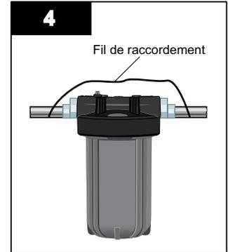
**Remarque :** si les conduites d'eau sont utilisées pour mettre à la terre le système électrique, les appareils électroménagers ou le téléphone, installer un fil de raccordement.
